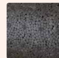
mousse moulée en polypropylène expansé, cellules fermées
